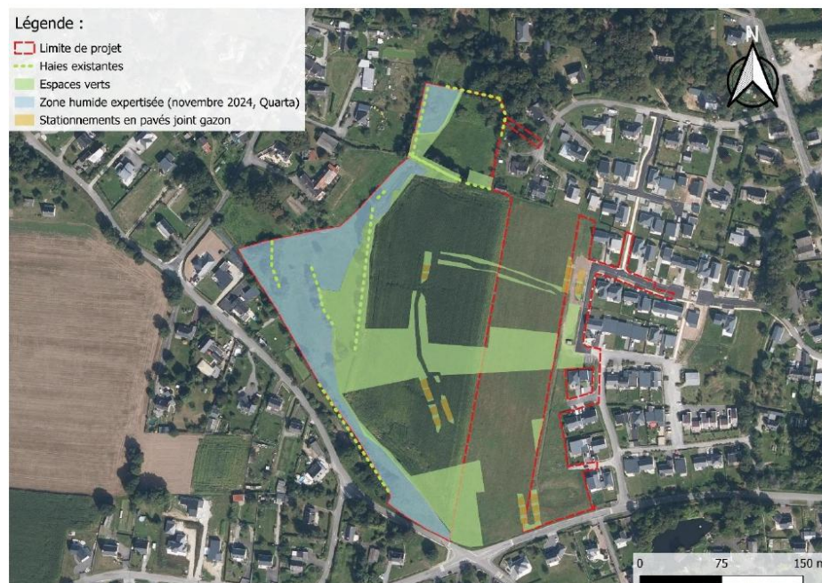
Aménagements permettant de limiter l'imperméabilisation des sols (Source : Quarta ; Fond : IGN Ortho)
