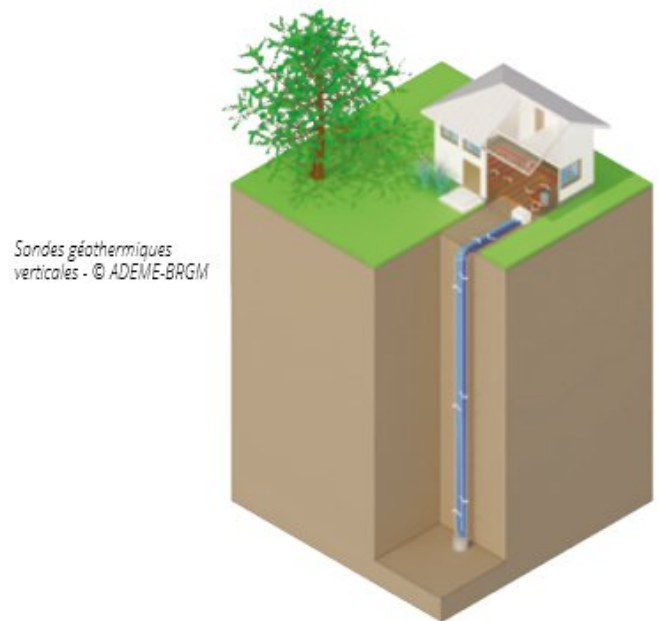
Figure 9. Sondes géothermiques en boucle fermée verticales [5]
